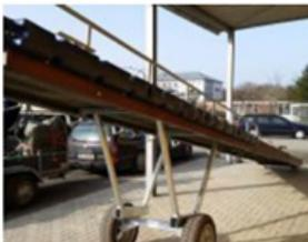
Nach ca. 120 Mann-Stunden steht er also da: Montiert mit Achsen, Bohlen, Fendern, Klampen und seitlichen Rollen damit er nicht an der Wand entlang kratzt.
